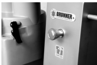
Der „Not - Aus-Schalter“ befindet sich unmittelbar neben dem Verschlusshebel.
