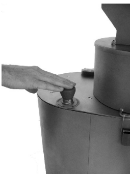
Der Not - Aus – Schalter, einfach zu erreichen auf der Oberseite des Gehäuses
