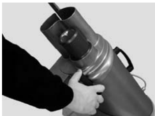
Der Verschlusshebel ist zugleich auch „Not - Aus-Schalter“. Er befindet sich unmittelbar neben der Austrittsöffnung auf der rechten Seite der Maschine.
