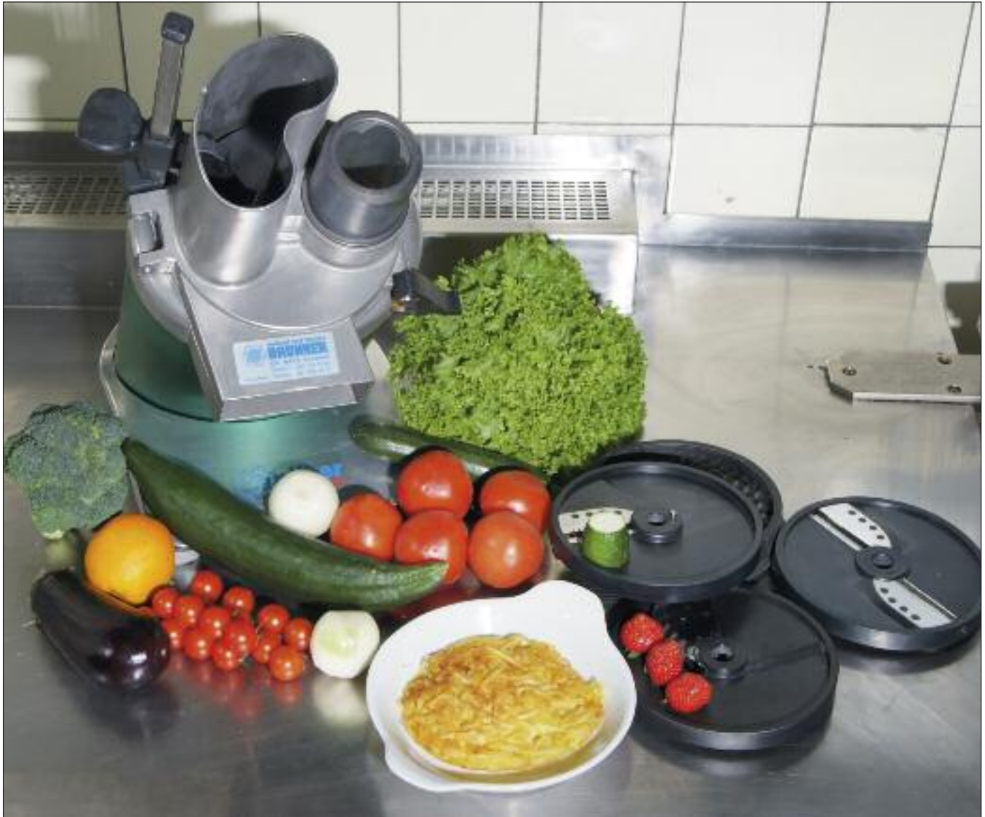
Die «Anliker5» der neusten Generation ist eine Universalschneidmaschine aus spülmaschinenfestem und antimikrobiellem Material. Sie schneidet Gemüse, Salate, Früchte, Kartoffeln, Nüsse und Schokolade präzise und schonend – und ohne die Zellstrukturen zu verletzen und zu zerquetschen.
