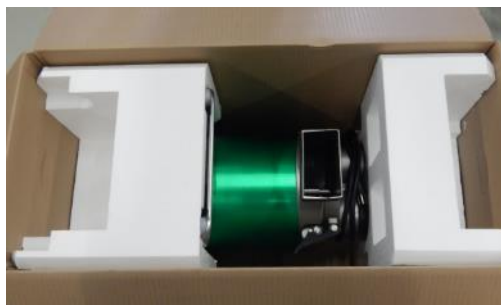
Fig. 10: GSM protégé par du polystyrène expansé
