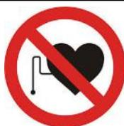
Danger potentiel pour les porteurs de stimulateurs cardiaques. Si l'on approche ou touche l'appareil, en particulier avec l'électrode, un dysfonctionnement du stimulateur cardiaque ne peut pas être exclu !
