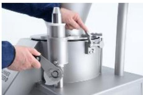
Simultanément, tourner le levier de la trémie vers la droite (dans le sens des aiguilles d'une montre jusqu'en butée) et soulever la trémie.
