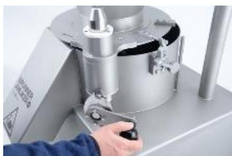
Illustration 18: Soulever la trémie en tournant le levier dans le sens des aiguilles d'une montre.
