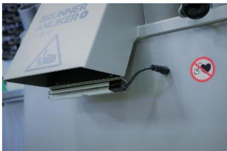
Illustration 4 : Système antistatique en sortie
