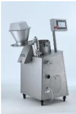
La trémie est maintenant complètement pivotée et le tambour et les ailettes de râpe peuvent être insérés ou retirés.
