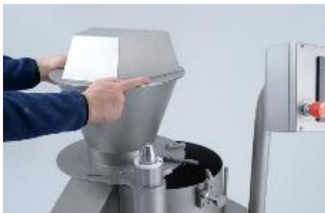
Illustration 25 : Pivoter la trémie au-dessus de la chambre de râpe
