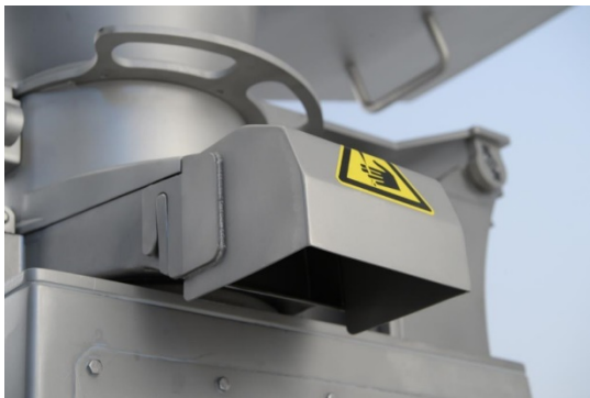
Abb. 31: Abdeckung auf Auslauf montiert
