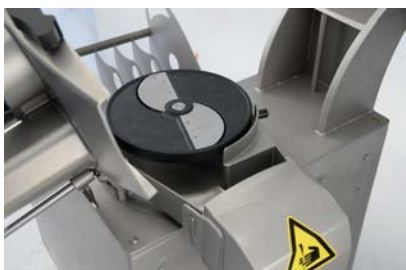
Abb. 24: Einfüllwanne und Aufsatzkopf weggeschwenkt
