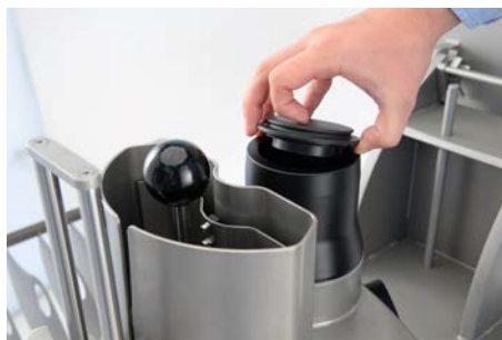
Abb. 30: Deckel auf Drehstutzen
