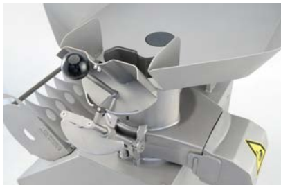
Abb. 23: Einfüllwanne auf Aufsatzkopf
