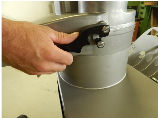
Fig. 17: Verrouiller la tête d'embout
