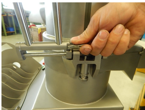
Fig. 18 : Insérer la tige de poussoir
