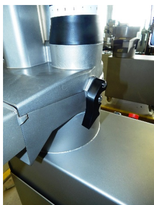
Fig. 29: Levier de blocage fermé
