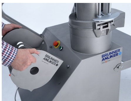
Fig. 37 : Montage du support de disque de coupe.
