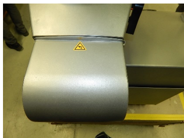
Fig. 31 : Monter le cache de sortie
