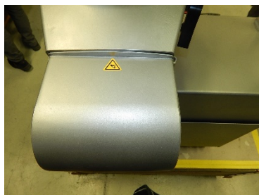
Fig. 31: Copertura montata sulla bocchetta di uscita
