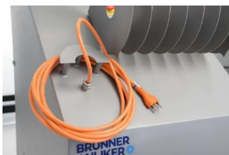
Fig. 13: Cavo di collegamento
