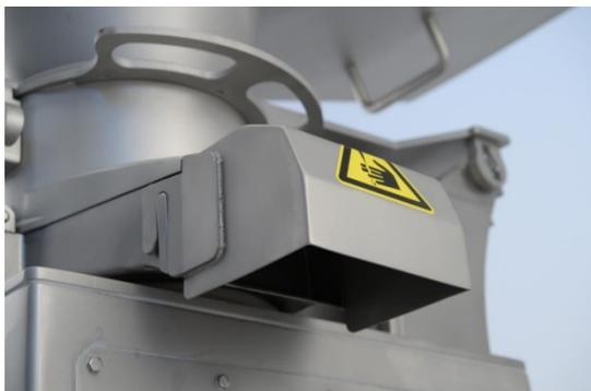
Fig. 35: Copertura montata sulla bocchetta di uscita
