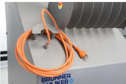
Fig. 15: Cavo di collegamento
