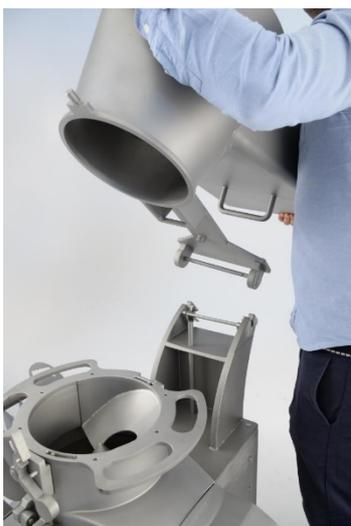
Inserire l'imbuto nella staffa di fissaggio, prestare attenzione all'allineamento preciso
