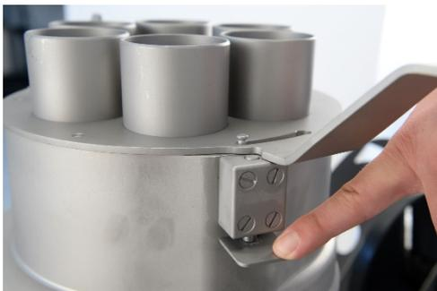
Per inserire il multifeeder è necessario ribaltare e togliere l'imbuto. Togliere anche la coclea a pala ed inserire poi il disco da taglio desiderato. Adesso è possibile inserire il multifeeder.
