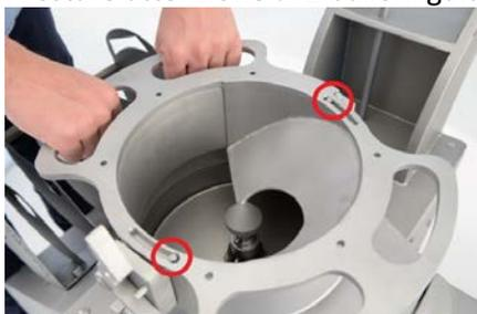
**Fig. 18** Inserimento della coclea a pala
