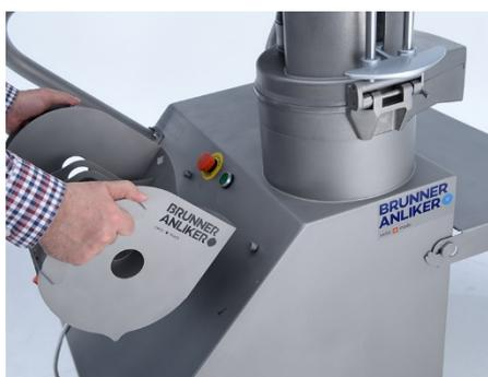
Sul tagliaverdure il portadischi da taglio viene fissato sui due ganci posti direttamente sotto il pulsante di ARRESTO DI EMERGENZA.
