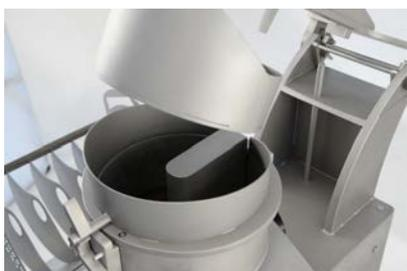
**Fig. 38:** Inserire il pestello dell'aletta neutra
