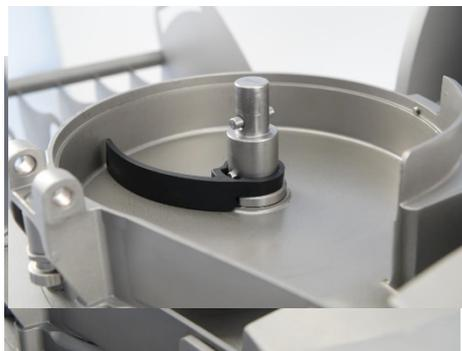
Prima di inserire il disco da taglio, è necessario montare l'espulsore o il piatto dell'espulsore. La posizione è corretta quando tocca quasi il fondo del vano da taglio. Senza estrattore/piatto dell'estrattore, il prodotto da tagliare si depositerebbe sotto al disco da taglio che si solleverebbe e danneggerebbe la testa da taglio e le lame
