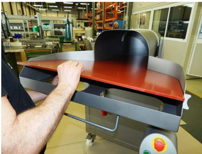
Abb. 26: Anheben der Kunststoffplatte
