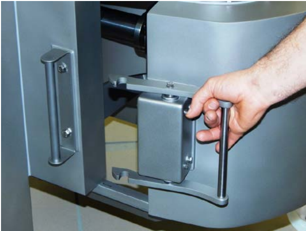
Abb. 11: Öffnen des Deckels
