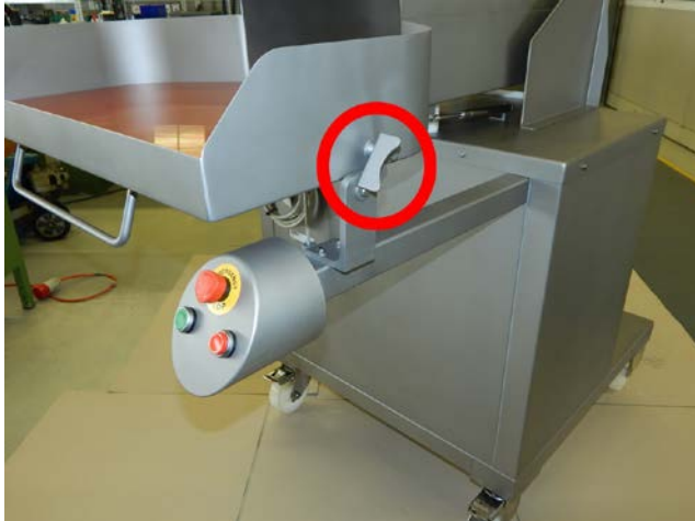
Abb. 25: Verriegelung der Rutsche
