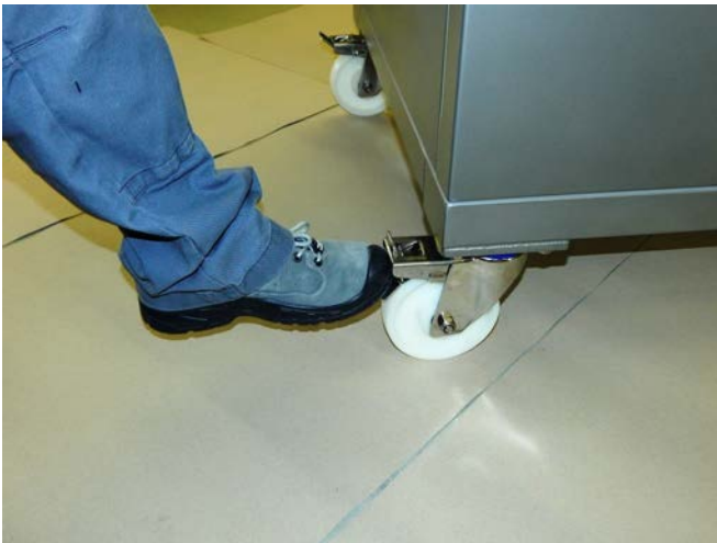
Abb. 9: Arretieren der Feststellbremse
