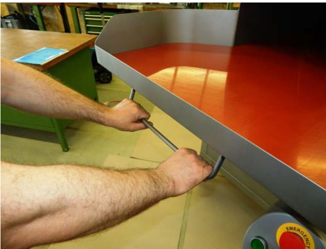
Abb. 24: Anheben der Rutsche
