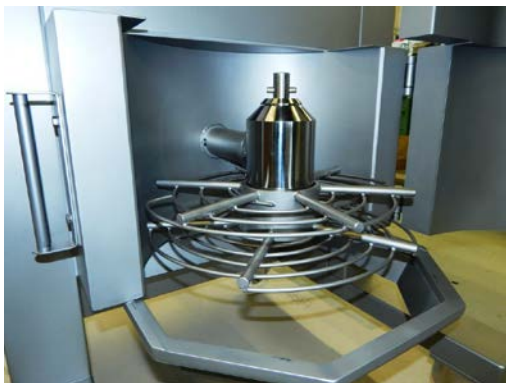
Abb. 23: Doppelspirale unten eingebaut
