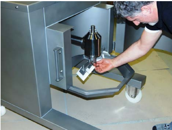
Abb. 13: Montage des Rakels
