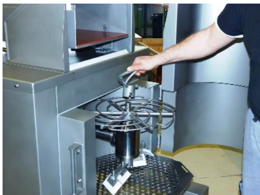
Fig. 17: Montaggio del gancio di prima spezzatura
