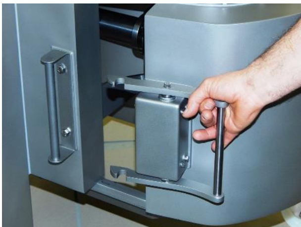
Fig. 11: Apertura della copertura
