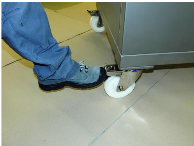
Fig. 9: Bloccaggio del freno di arresto
