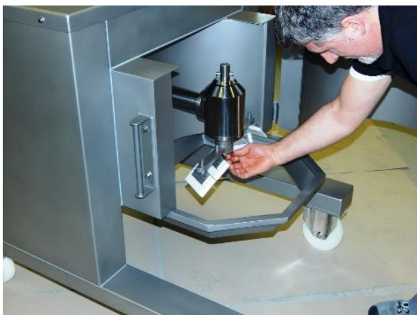
Fig. 13: Montaggio della racla
