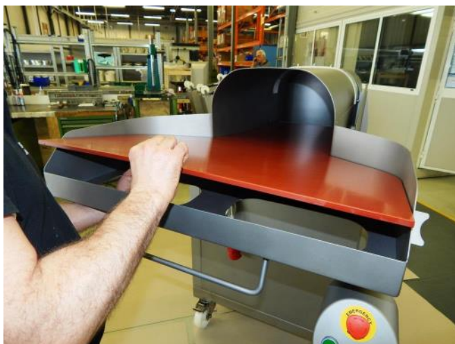
Fig. 26: Sollevamento della lastra in materiale plastico
