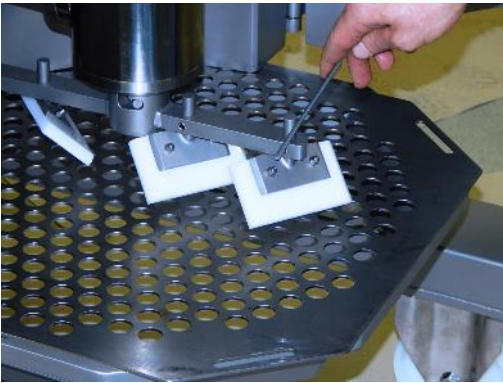
Fig. 19: Regolazione / sbloccaggio della racla
