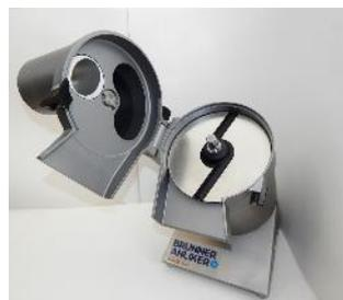
Bevor eine Scheibe eingesetzt wird, muss der Auswerfer oder Auswurfteiler montiert werden, korrekt eingesetzt berührt dieser beinahe den Boden des Schneideraums. Ohne Ausräumer/ Auswurfteiler staut sich das Schnittgut unterhalb der Schneidescheibe, die Scheibe wird nach oben gedrückt und zerkratzt den Schneidekopf und die Messer sind beschädigt
