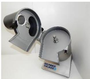
Um eine Schneidscheibe einlegen zu können, wird zuerst der Verschlusshebel geöffnet und der Aufsatzkopf nach links geschwenkt.
