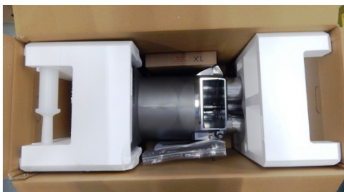
Fig. 10: GSM protégé par du polystyrène expansé
