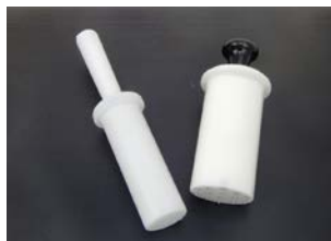
Immagine 5: Pestello standard e pestello rotante
