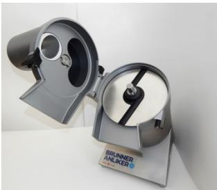
Avant de mettre en place le disque, il faut d'abord monter l'éjecteur ou le disque éjecteur. Si celui-ci est correctement placé, il touche presque au fond de la chambre de coupe. Si l'éjecteur/le disque éjecteur n'est pas monté, les produits coupés s'accumuleront au-dessous du disque de coupe, lequel sera, par conséquent, poussé vers le haut et causera, ainsi, des égratignures sur la tête et un endommagement des lames.
