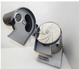
Embrochez maintenant le disque sur l'arbre moteur. En tournant légèrement, le disque s'encliquette sur la clavette d'entraînement disposée sur l'arbre moteur. Ainsi, le disque est correctement logé et aligné pour former une surface plane avec l'extrémité de l'arbre moteur.
