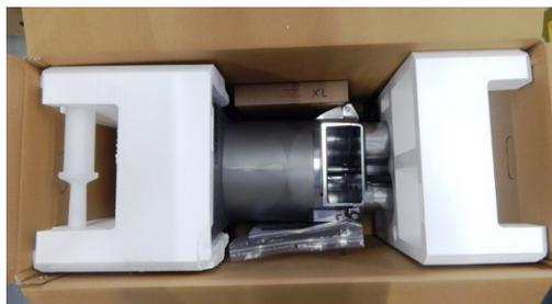
Fig. 10: GSM protégé par du polystyrène expansé
