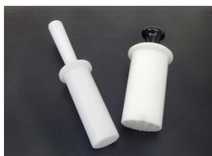
Fig. 5: Poussoir standard et poussoir tournant
