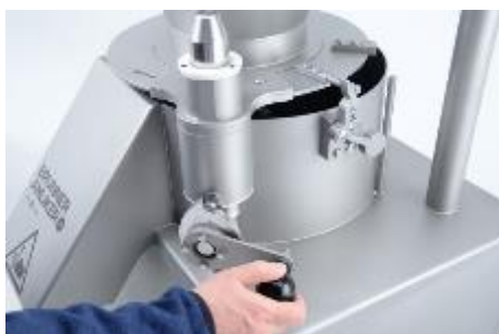
Abbildung 18: Trichter mit einer Hebedrehung im Uhrzeigersinn anheben
