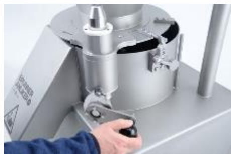
Figura 18: Sollevare la tramoggia ruotando la leva in senso orario.
