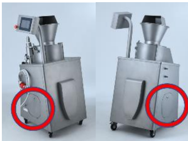
Figura 37: Aperture di servizio
