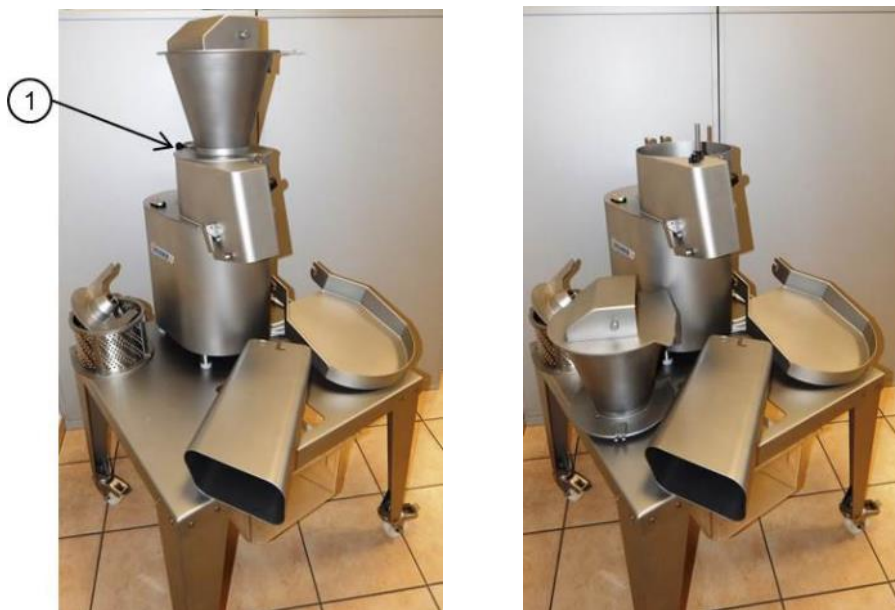
Abbildung 15/16: Maschine bereit für Reinigung
