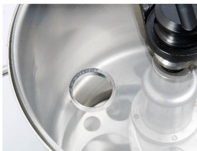
Durch die Einfüllöffnung können Zusatzstoffe, Aromen, Bindemittel etc. während der Verarbeitung zugegeben werden
