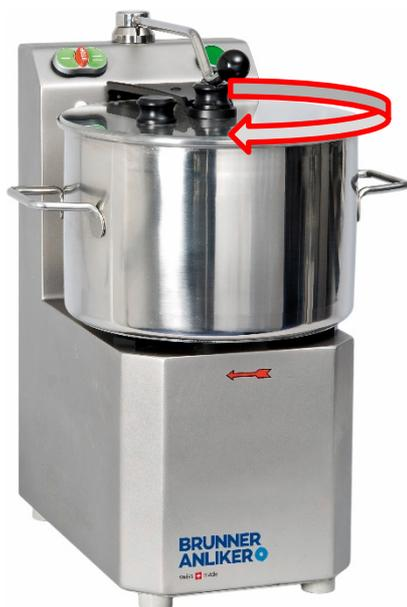
Der Cutter läuft nur bei geschlossenem Verriegelungshebel. Der Deckel muss aufgesetzt sein, dann wird der Verriegelungshebel im Uhrzeigersinn bis an den Anschlag auf dem Deckelzapfen gedreht.
